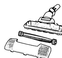
5 吸口本体、カバー、回転ブラシが十分に乾燥したのを確認してから、回転ブラシを取り付けます。
