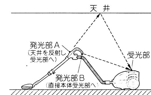
一度押して運転が切り換わらないときは、手もと操作部の角度を変えて何度も押し直してください。
