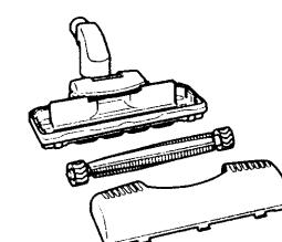
5 吸口本体、カバー、回転ブラシが十分に乾燥したのを確認してから、回転ブラシを取り付ける。
