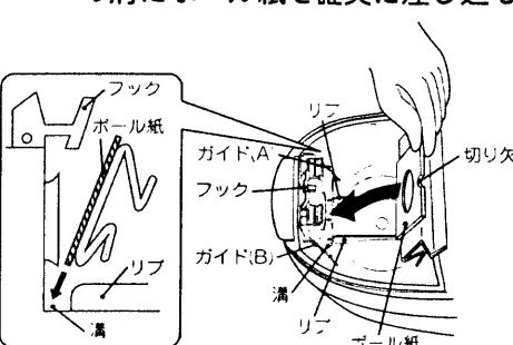
2 ボール紙を矢印方向に両手で押しつけ、フックのつめに確実にひっかける。(ボール紙をフックの取り付け線に合わせる)
