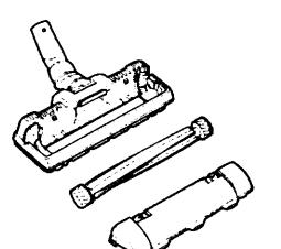
5 吸口本体、カバー、回転ブラシが十分に乾燥したのを確認してから、回転ブラシを取り付ける。
