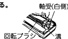
●軸受を左右の溝に入れます。(図のように右側の溝に軸受け(白側)を入れます)
