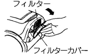
2 フィルターカバーに新しいフィルターを取り付ける。
