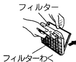
3 フィルターを水で軽くもみ洗いし、たたいて水気を切り、十分に自然乾燥させる。
