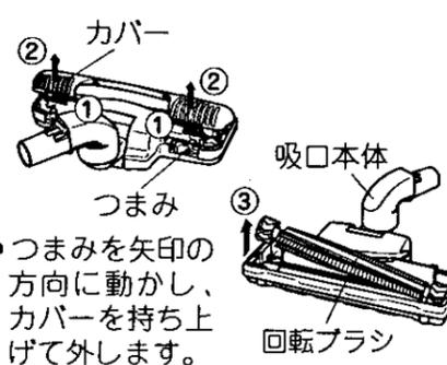
●つまみを矢印の方向に動かし、カバーを持ち上げて外します。
