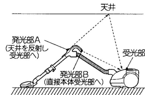
一度押して運転が切りかわらないときは、手もと操作部の角度を変えて何度か押し直してください。光が届かないような所で掃除する場合は、本体スイッチで操作してください。👉6
