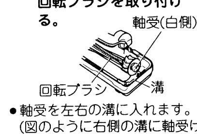
•軸受を左右の溝に入れます。(図のように右側の溝に軸受け(白側)を入れます)
