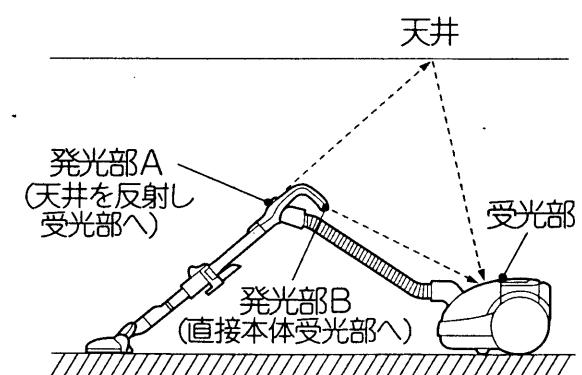
一度押して運転が切り換わらないときは、手もと操作部の角度を変えて何度も押し直してください。光が届かないような所で掃除する場合は、本体スイッチで操作してください。 9
