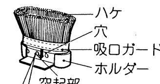
吸口ガードの穴とホルダーの突起部を合わせる。
