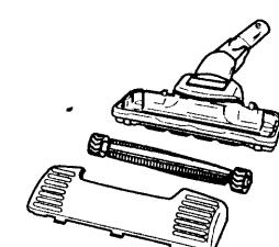
5 吸口本体、カバー、回転ブラシが十分に乾燥したのを確認してから、回転ブラシを取り付けます。
