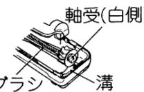
●軸受を左右の溝に入れます。(図のように右側の溝に軸受(白側)を入れます)
