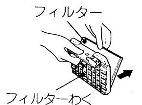
3 フィルターを水で軽くもみ洗いし、たたいて水気を切り、十分に自然乾燥させる。
