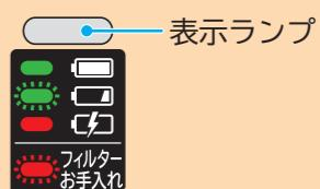
「ダストケース」のごみを捨て、「クリーンフィルター」・「スポンジフィルター」・「内筒フィルター」をお手入れ(水洗い)してください。→(P.3、4)
