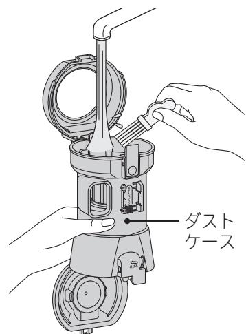
キャップ部を矢印の方向に10回程度動かして水洗いしてください。
