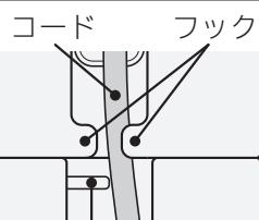
充電台の○部3か所で、コードをフックの間に差し込み、突起を避けるように沿わせてください。
