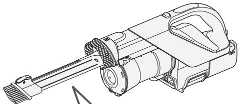
すき間吸口に切り替えるときは、ボタンを押しながら、矢印の方向にブラシを移動させます。
