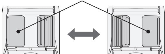
排気方向切替シャッターを左右に切り替え、排気の向きを変えられます。
