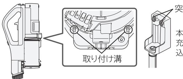
本体の取り付け溝を充電台の突起に差し込みます。
