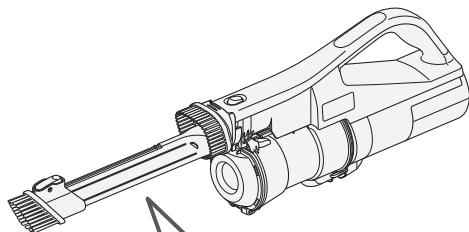
すき間吸口に切り替えるときは、ボタンを押しながら、矢印の方向に移動させます。
