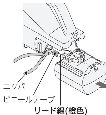
3 残りのすべてのリード線を1本ずつ電池から約2cmの位置でニッパなどで切断し、1本ずつビニールテープを巻いて絶縁する
