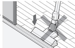
●敷居の段差などにパワーへッドを強く押しつけてご使用になると、車輪などが摩耗したり、床面に傷を付けることがあります。
