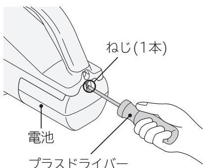
2 電池を引き出し、電池と本体をつないでいる橙色のリード線を、電池から約2cmの位置でニッパなどで切断し、ビニールテープを巻いて絶縁する
