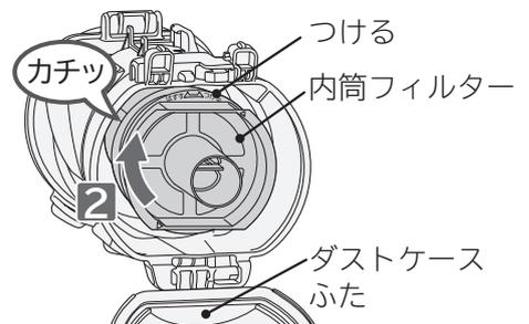
**お願い** 内筒フィルターはしっかり取り付けてください。ごみ捨ての際に内筒フィルターが落下したり、しっかり取り付けていない状態で本体を運転した場合、内筒フィルター付近から異音が発生することがあります。
