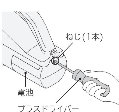
**2** 電池を引き出し、電池と本体をつないでいる橙色のリード線を、電池から約2cmの位置でニッパなどで切断し、ビニールテープを巻いて絶縁する
