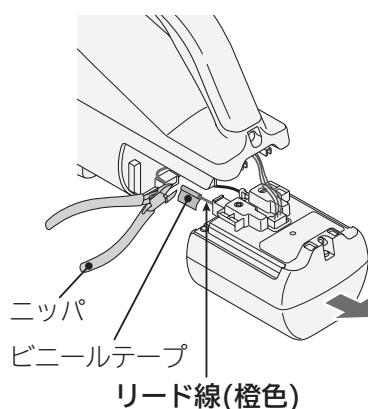
**3** 残りのすべてのリード線を1本ずつ電池から約2cmの位置でニッパなどで切断し、ビニールテープを巻いて絶縁する
