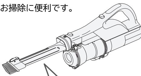
ブラシを移動させるときは、ボタンを押しながら矢印の方向に移動させます。
