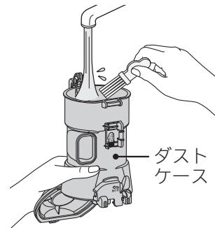
内容先端部を矢印の方向に動かして水洗いしてください。
