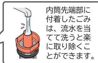
内筒先端部を矢印の方向に動かして水洗いしてください。
