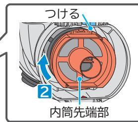
お願い 内筒フィルターはしっかりと取り付けてください。ごみ捨ての際に、内筒フィルターが落下したり、しっかりと取り付けていない状態で本体を運転した場合、内筒フィルター付近から異音がすることがあります。
