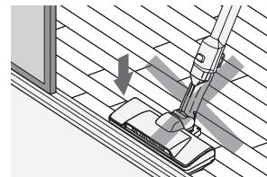
●敷居の段差などにパワーヘッドを強く押しつけてご使用になると、車輪などが摩耗し、床面に傷を付けることがあります。
