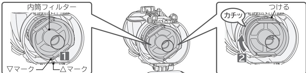
**お願い** 内筒フィルターはしっかり取り付けてください。ごみ捨ての際に内筒フィルターが落下したり、しっかり取り付けていない状態で本体を運転した場合、内筒フィルター付近から異音が発生することがあります。
