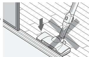
●敷居の段差などにパワーHEADを強く押しつけてご使用になると、車輪などが摩耗したり、床面に傷を付けることがあります。
