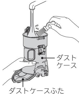
内筒先端部を矢印の方向に動かして水洗いしてください。
