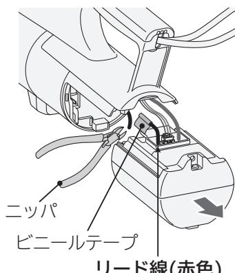
**3** 残りのすべてのリード線を1本ずつ電池から約2cmの位置でニッパなどで切断し、ビニールテープを巻いて絶縁する
