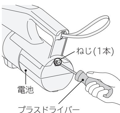
**2** 電池を引き出し、電池と本体をつないでいる赤色のリード線を、電池から約2cmの位置でニッパなどで切断し、ビニールテープを巻いて絶縁する
