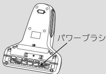
パワーブラシに異物を挟み込んだ状態で運転を続けると、モーターの過熱を防ぐために、自動的にパワーブラシの回転を停止します。
