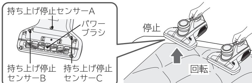
持ち上げ停止センサーAを布面につけた状態で、持ち上げ停止センサーB・Cの両方もしくはどちらかを布面につけると、パワーブラシが回転します。
