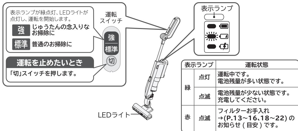
表示ランプが赤点滅した場合に、パワー ヘッドのモーターの過熱を防ぐため、自動的に回転ブラシ・LEDライトを停止することがあります。
