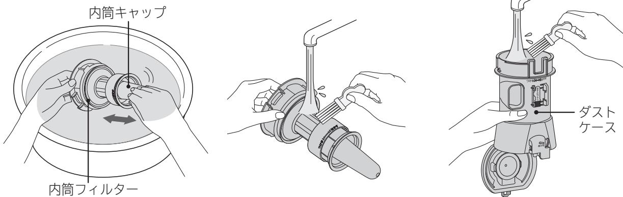
内筒キャップを矢印の方向に10回程度動かして水洗いしてください。
