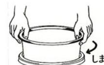
3 うすをボイラーネジに正しくはめこみ、矢印「しまる」の方向へ回して確実にしめつけてください。
