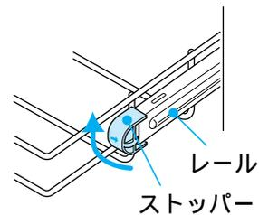
**2** 左右のレール先端に付いているストッパーを外側に回転させてください。上かごが取り出せます。
