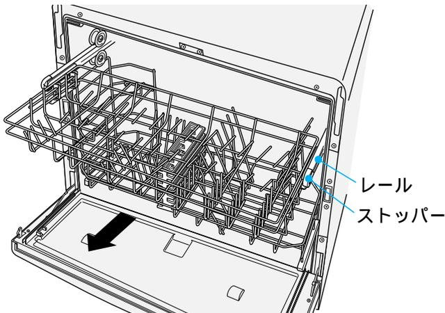
**4** 上かごを押し込み、左右のレール先端に付いているストッパーを内側にカチッと音がするまで回転させてください。
