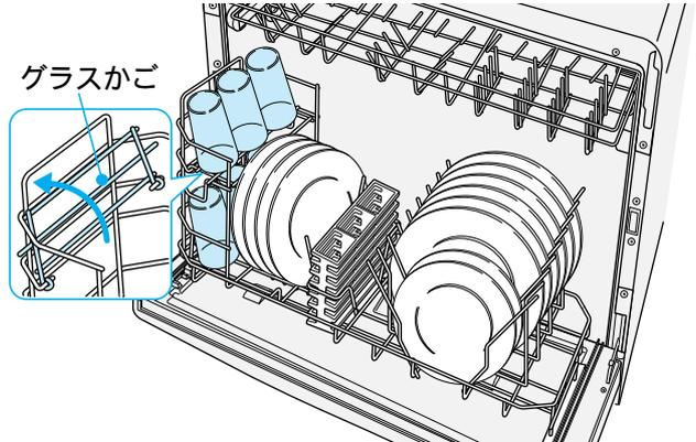
\* コップ類は、グラスかごを回転させて、3個セットした後にグラスかごを元に戻して、その上に3個セットしてください。(高さ12cm以下のコップが6個収納できます)
