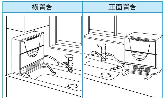
本体背面を壁にくっつけない場合は、補助金具(後)、または、補助金具(横)を取り付けてください。
