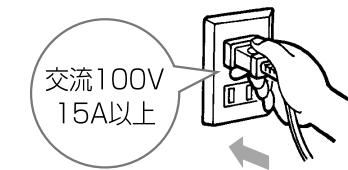
【ご注意】差込プラグをコンセントに差し込む時は、必ずスイッチツマミが「切」の位置になっていることを確認してください。
