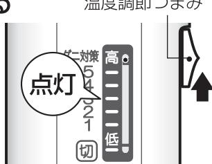
①温度調節つまみを「切」から「高」側にスライドすると電源が入り、電源ランプが点灯します。
