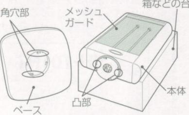
②本体の凸部にベースの角穴部を合わせて、はめ込む。(ベースは、前後どちらの方向でも取り付けて使用できます。)
