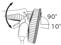
下方向約10°～上方向約90°まで11段階に調節できます。
