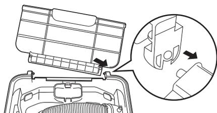
②左側ふたの軸受け溝に本体軸をふたを縦にした状態で下方向にカチツとなるまで押し込む。
