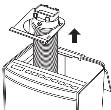
**4** 図のように折り畳むようにして固定する。
