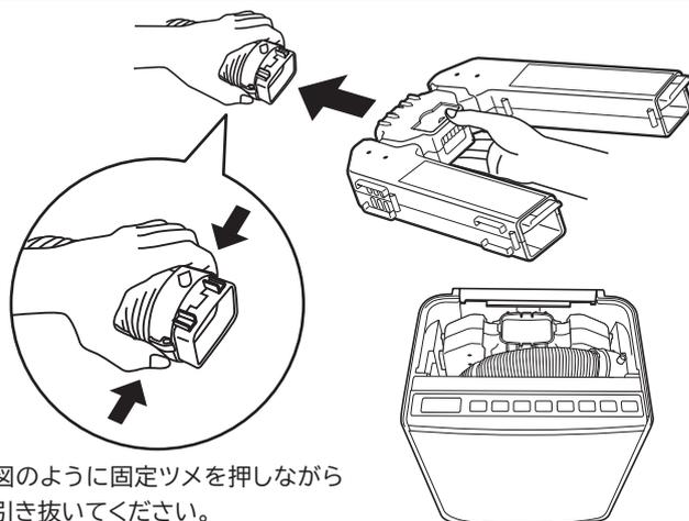
図のように固定ツメを押しながら引き抜いてください。
