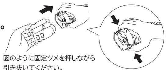
図のように固定ツメを押しながら引き抜いてください。
