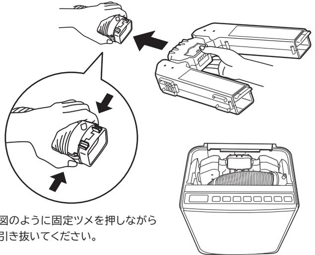
図のように固定ツメを押しながら引き抜いてください。
