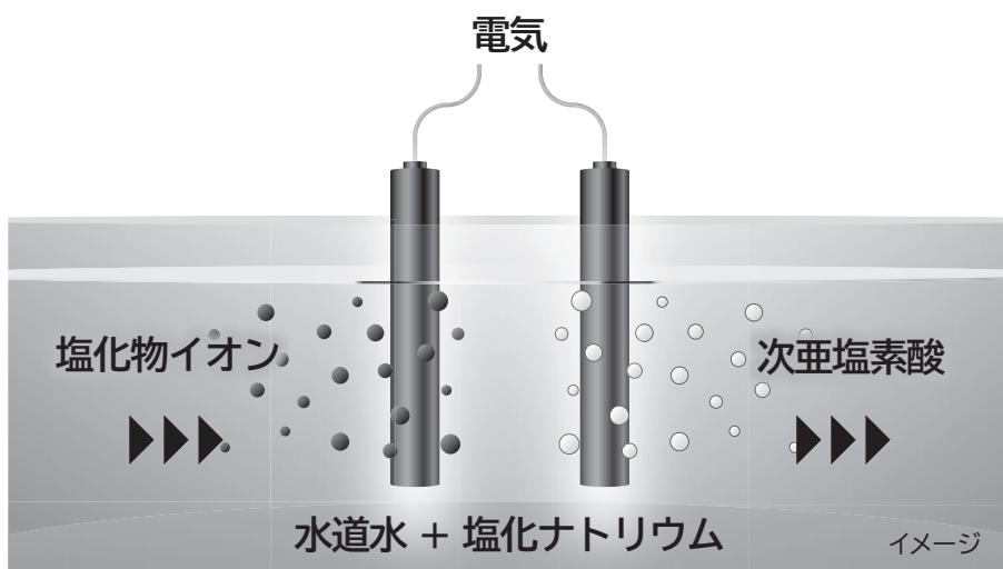
水道水と塩化ナトリウムを電気分解することで、除菌効果を発揮する「次亜塩素酸」を生成します。
