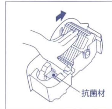
気化フィルターを水平にする。入りづらい時は少し回転させる。
