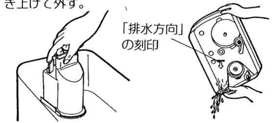
図のように、本体に刻印されている排水方向に本体を静かに傾け、排水します。
