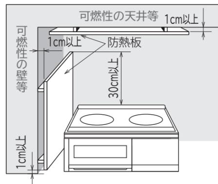
防熱板はこれを設けたとき、機器周囲の可燃物の温度が室温35℃の時100℃を越えない断熱性を有すること。
