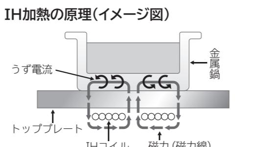
IHとは電磁誘導加熱(Induction Heating)のこと。IHコイルから発生した磁力(磁力線)が、金属製の鍋を通ると、うず電流が発生し鍋自身を発熱させます。
