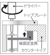
※後固定金具が持ち上がり、※カウンタートップの厚み カウンタートップに固定 され、シール性が確保さ れます。
