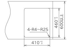
☆カウンタートップの取付け穴(開口寸法はJISで定められています) ※ 部分への突起は不可。
