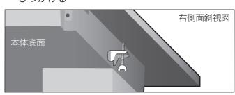
3.カウンタートップへ蝶ボルトを締め付ける
