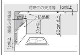
防熱板はこれを設けたとき、機器周囲の 可燃物の温度が室温35℃の時100℃を越 えない断熱性を有すること。
