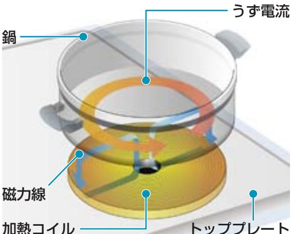
コイルに電流を流すと磁力線が発生します。この磁力線の中に鍋を置くと、鍋にうず電流が発生し、鍋の電気抵抗によって鍋自体が発熱します。
