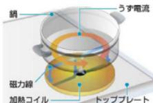
コイルに電流を流すと磁力線が発生します。この磁力線の中に鍋を置くことで鍋にうず電流が発生し、鍋の電気抵抗によって鍋自体が発熱します。
