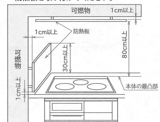
防熱板はこれを設けたとき、機器周囲の可燃物の温度が室温35°Cの時100°Cを越えない断熱性を有すること。
