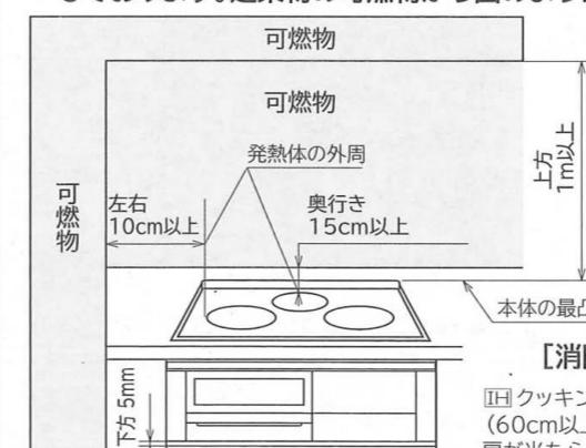
■左記寸法がとれない場合には、不燃材による防熱板を取り付けてください。
