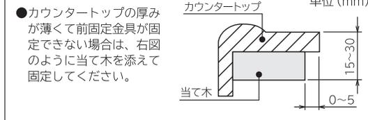
●カウンタートップの厚みが薄くて前固定金具が固定できない場合は、右図のように当て木を添えて固定してください。
