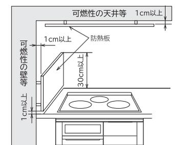
防熱板はこれを設けたとき、機器周囲の可燃物の温度が室温35℃の時100℃を越えない断熱性を有すること。本体の後面に取り付ける場合も、側面と同じ距離を設けてください。
