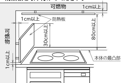
防熱板はこれを設けたとき、機器周囲の可燃物の温度が室温35℃の時100℃を越えない断熱性を有すること。
