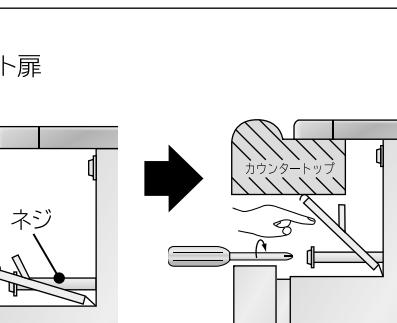
●カウンタートップの厚みが薄くて前固定金具が固定できない場合は、右図のように当て木を添えて固定してください。
