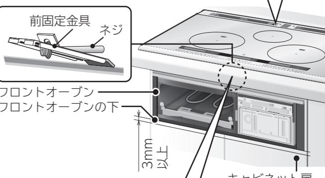
カウンタートップの厚みが薄くて前固定金具が固定できない場合は、右図のように当て木を添えて固定してください。
