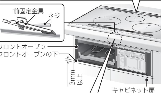
カウンタートップの厚みが薄くて前固定金具が固定できない場合は、右図のように当て木を添えて固定してください。
