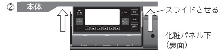
化粧パネル下の左右の溝に前面操作部のフランジ部をはめ込んで、下にスライドさせてください。
