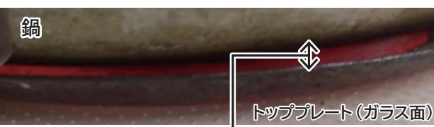
鍋底がはがれかけた状態で加熱し、はがれた部分が異常過熱して赤熱している
